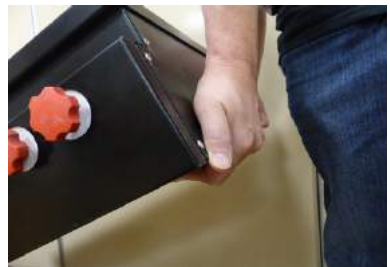
Richtige Trageposition des Fair-o-mat® Münzprüfer, Seitenblende und Tür nicht belasten.
